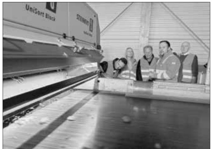
*An dieser Arbeitsstation werden mittels Detektoren und Luftdruck Plastikbestandteile aus dem Biomüll entfernt - den Vorgang beobachten (von links) Landrat Florian Töpfer, Kreisrätin Simone Kreß, Landtagsabgeordneter und Kreisrat Paul Knoblach, Projektingenieur Philipp Strauß und Kreisrat Erich Servatius.*
